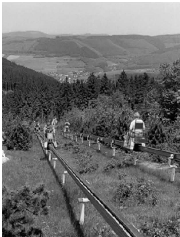
Изолированные контактные рельсы U 20 в качестве токоподвода для увеселительной дороги
